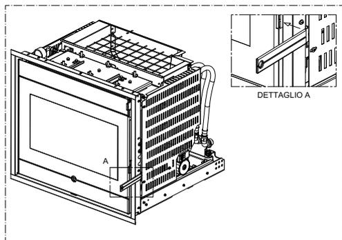
Votre appareil est fourni d'une poignée amovible pour ouvrir et fermer la porte du foyer de façon à pouvoir effectuer les opérations de nettoyage requises (voir paragraphe spécifique). Après avoir conclu ces opérations, il est recommandé de retirer la poignée pour éviter toute ouverture accidentelle de la porte.
