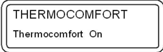
**ATTENTION** : Il sera possible d'activer la fonction THERMOCOMFORT et ensuite de sélectionner ON sur la page-écran précédente, uniquement si l'appareil capte le signal de la radiocommande. Il est donc recommandé de s'assurer que la radiocommande est allumée et se trouve à proximité de l'appareil.
