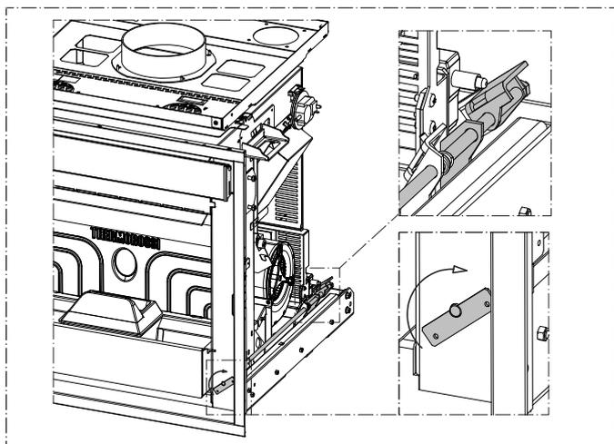
3) Tourner à 90 degrés dans le sens des aiguilles d'une montre le bloc anti-extraction.
