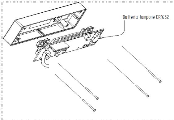
Une batterie tampon de type CR 1632 est présente à l'intérieur du tableau de commande. Lorsque l'heure et la programmation ne restent pas en mémoire (ce dysfonctionnement n'est pas considéré comme un défaut car il est dû à une usure/consommation normale) il faut procéder à son remplacement en agissant sur les 4 vis placées à l'arrière du tableau de commande. Une fois ôtée, la pile usée doit être éliminée en toute sécurité.
