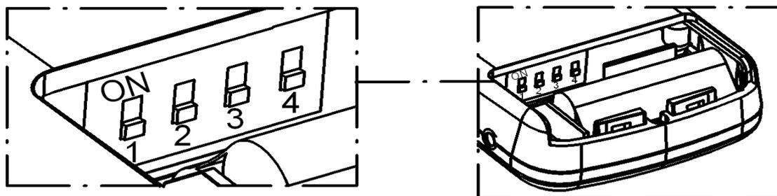
SÉLECTEUR DE CODES POUR RADIOCOMMANDE PORTABLE
