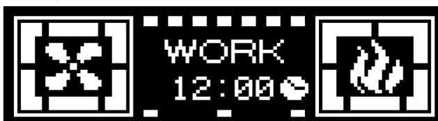
Pour être opérante, la programmation doit être activée, pour activer/désactiver la programmation, appuyer sur la touche Horloge. Programmation activée : la mention « CR.ON » apparaît momentanément sur le display et un voyant apparaît en bas à droite du display. Cette activation inhibe le fonctionnement d'un éventuel chrono thermostat additionnel. Programmation désactivée : la mention « CR.OFF » apparaît momentanément sur le display.
